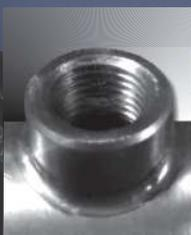
Wasseranschluss am gekühlten Rohrstück: G 1/4" Whitworth-Rohrgewinde
