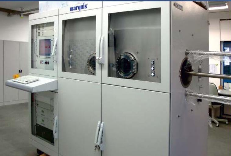
Die Ausgastestanlage dient der Messung des Desorptionsverhaltens von Materialien in einer definierten Vakuumumgebung.
