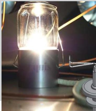
Die Rezipientenleuchte MRL dient zum Ausleuchten des Rezipienten und ermöglicht so die visuelle Prozessbeobachtung. Durch die Trennung von elektrischer Durchführung und Leuchtenkörper ist die Rezipientenleuchte flexibel im Aufstellort. Ein Auswechseln von defekten Leuchtmitteln ist selbständig möglich, es werden dazu handelsübliche Halogen-Stiftsockellampen benötigt.
